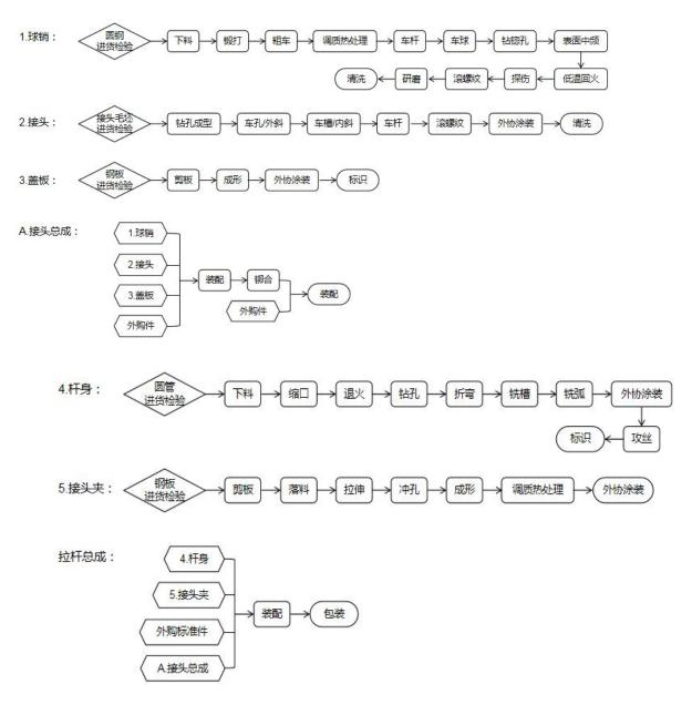
图 3-7 拉杆总成工艺流程图
