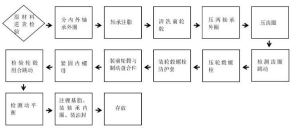
图 3-4 轮毂组合工艺流程图
