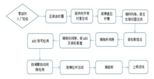
图 3-5 鼓式前桥装配工艺流程图
